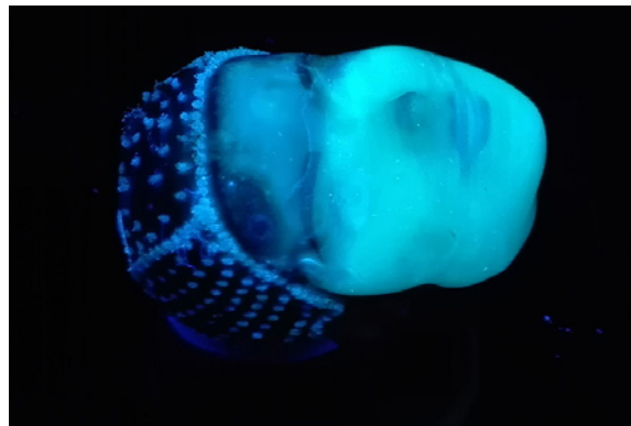
Bakterienhaltige Tinte lässt sich auch auf eine komplexe dreidimensionale Oberfläche wie diesen Puppenkopf drucken. Foto: Labor für komplexe Materialien / ETH Zürich
